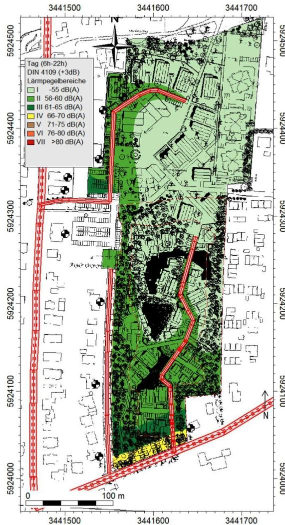
**Abbildung 8:** Verlauf der Lärmpegelbereich im stärker belasteten Tagzeitraum in Form eines Immissionsrasters mit der Aufpunkthöhe von 4,8 m Oberkante Gelände (entspricht dem 1. Obergeschoss).
