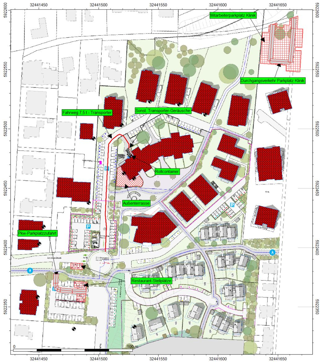
**Abbildung 3:** Lageplan mit den beurteilungsrelevanten, gewerblichen Geräuschquellen der Vor- und Zusatzbelastung.
