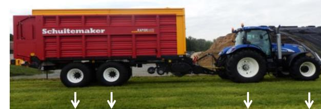
**Achslast:** Gesamtlast, die von den Rädern einer Achse oder einer Achsgruppe auf die Fahrbahn übertragen wird.
