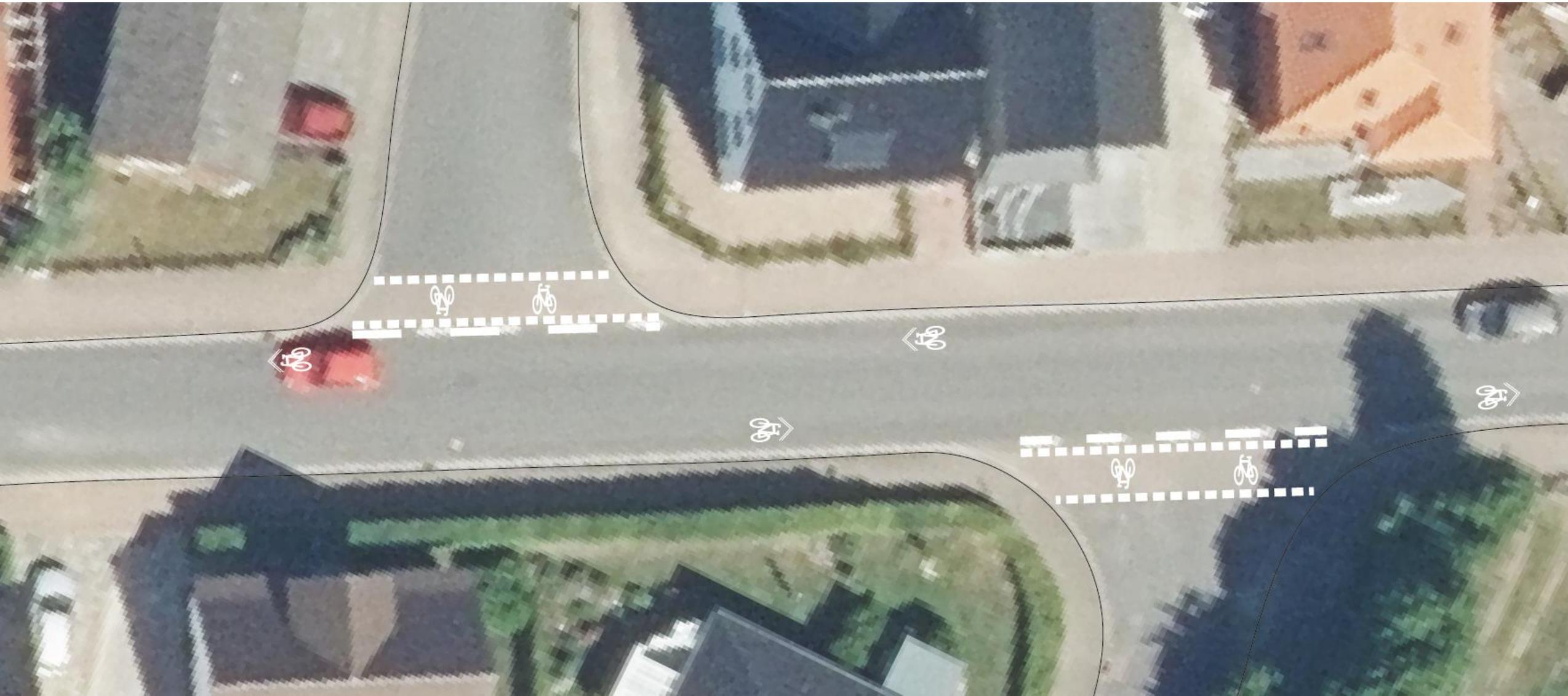
Sofern die Zufahrt gesichert werden kann (deutlicher Rückschnitt der Hecke und „bauliche Sicherung“ des Hauseingangs durch Beet o.ä.) sollte die Überleitung des Radverkehrs auf die Fahrbahn hier stattfinden
