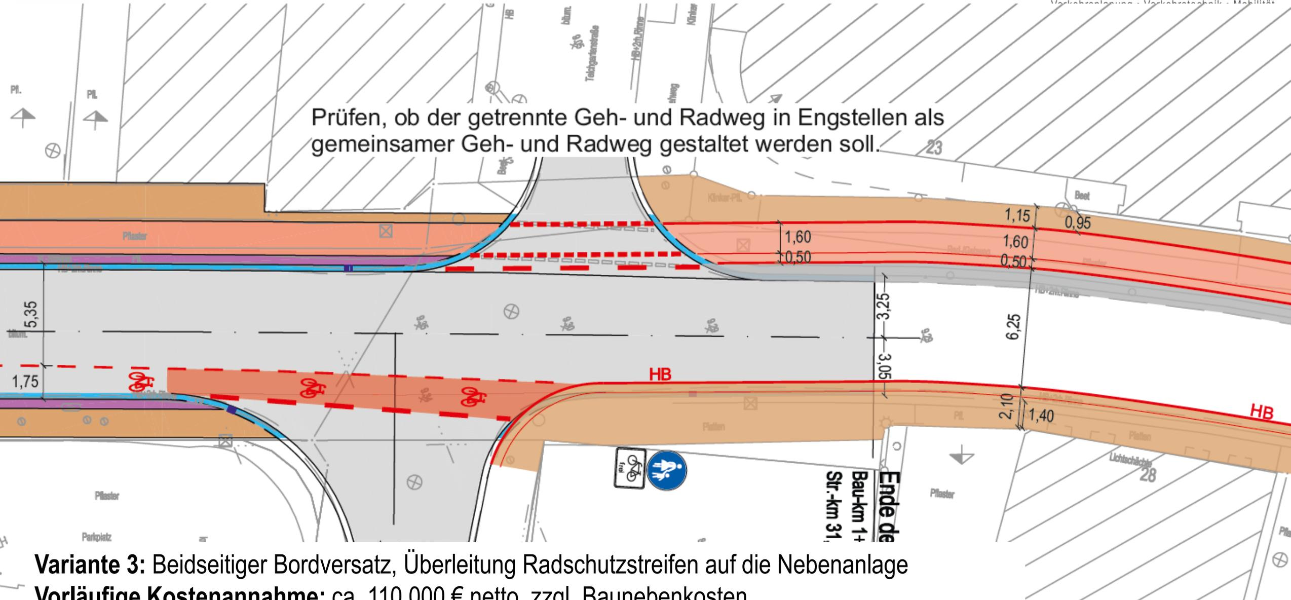
**Variante 3:** Beidseitiger Bordversatz, Überleitung Radschutzstreifen auf die Nebenanlage
