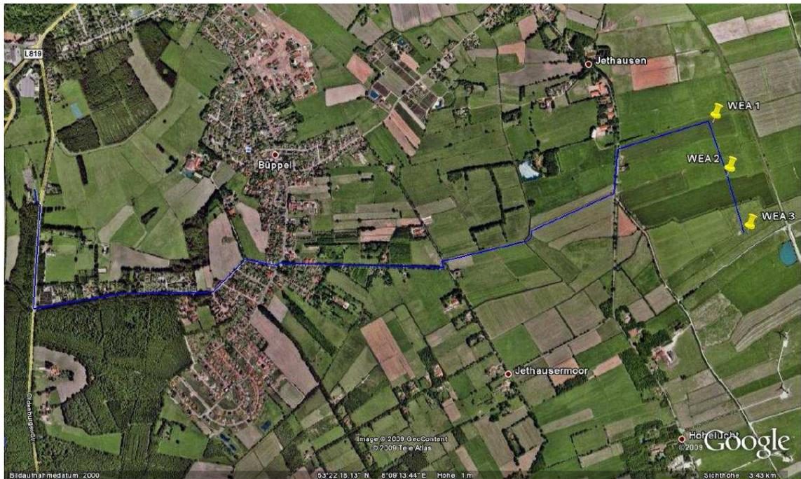
Abb. 4 Geplante Netzanbindung vom Windpark Hohlucht zum UW Varel
