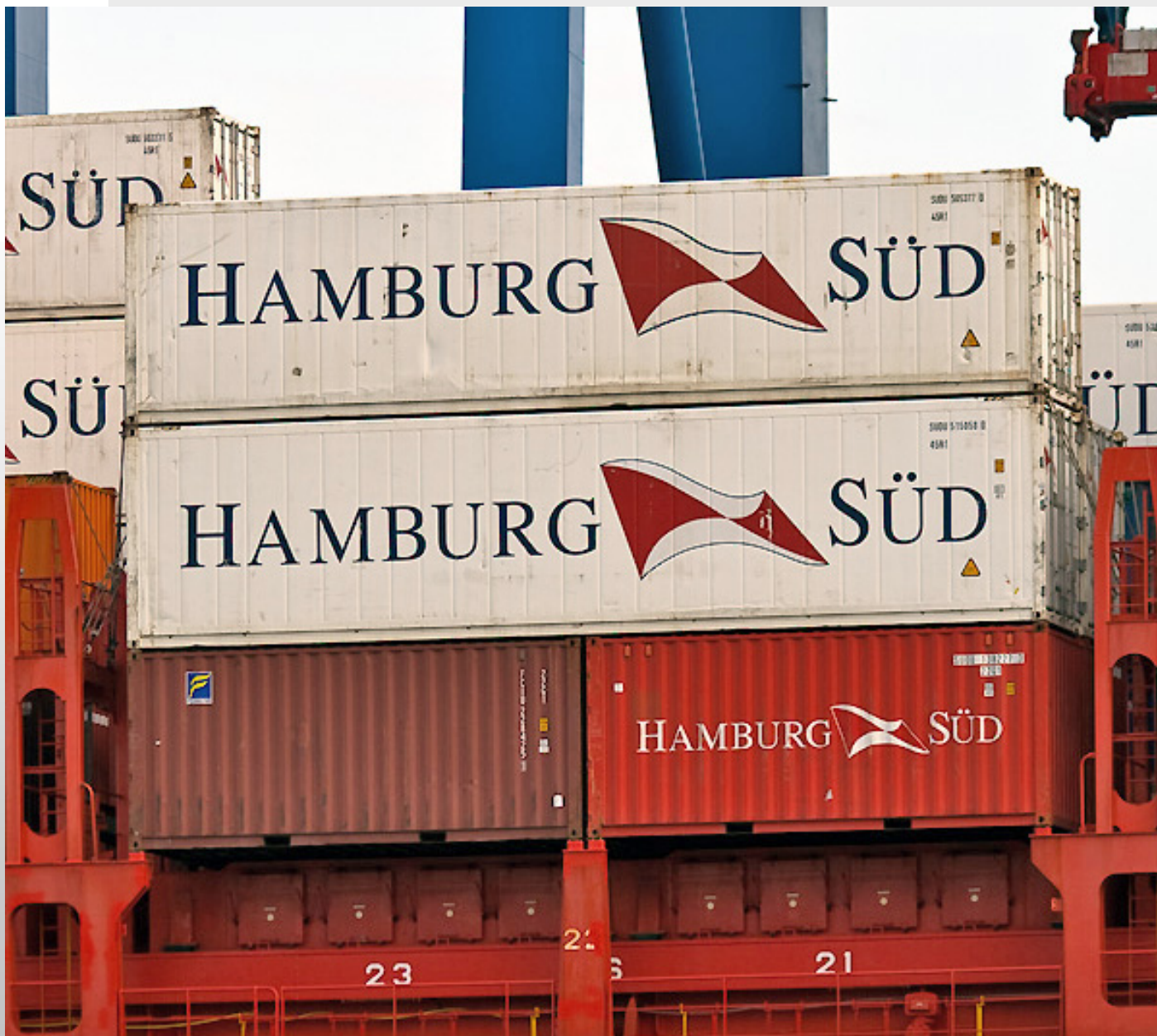
Zwei 40-Fuß-ISO-Container (jeweils 2 TEU oder 1 FEU) oben, darunter zwei 20-Fuß-ISO-Container (jeweils 1 TEU).
