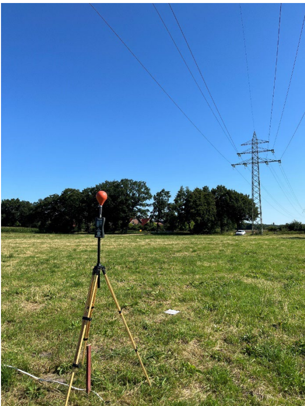
Bild 3-3: Messreihe 2, exemplarisch Messort 2.1, unterhalb der Mittelachse der 110 kV Freileitung
