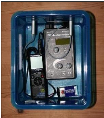
Abbildung 8: Beispiel für den Aufbau einer Horchkiste
