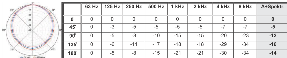
Abbildung 6: Darstellung des Richtwirkungsmaßes für die Lautsprecher der Beschallungsanlagen.
